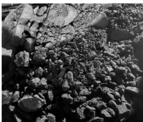
图 10 采场试验爆破效果
