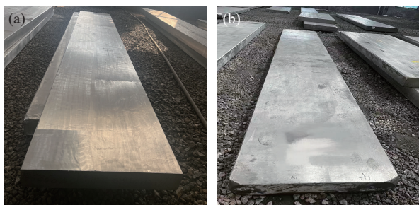
图 1 TC4 钛合金板坯: (a) 1 # 板坯 (常规铣面); (b) 2 # 板坯 (表面包覆纯钛)
