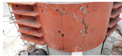
b) 抱箍承载力试验现场照片
