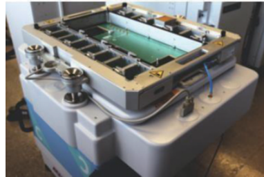
图 1 Advantest V93000 的 HSIO 高速测试系统
