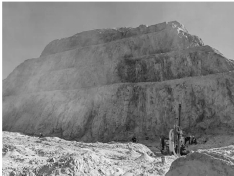
图 4 英德下太石英砂矿新技术预裂爆破效果 Fig. 4 New technology blasting effect in Yingde
