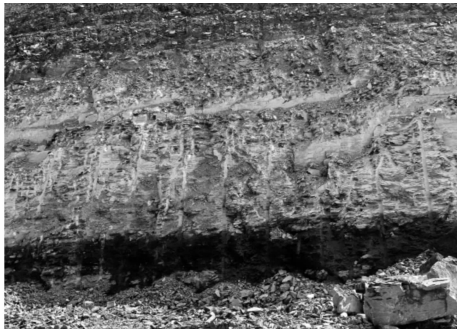
图 5 开平粉砂岩矿传统预裂爆破效果 Fig. 5 Traditional presplitting blasting effect in Kaiping
