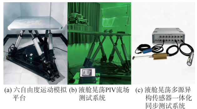
图 3 液舱晃荡实验测试系统
