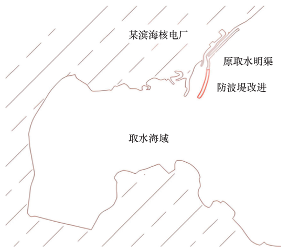
图 9 某滨海核电厂取水防波堤现状及改进方案
