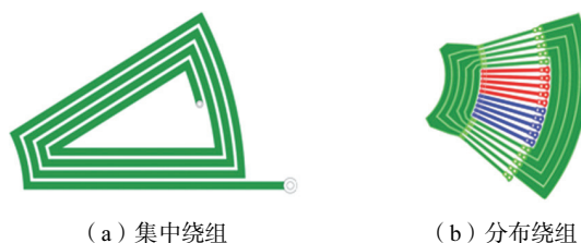
图 2 不同 PCB 定子绕组示意
