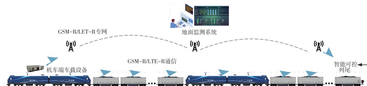
图3 智能列尾系统总体方案架构图
