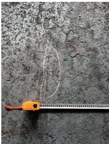
图1 铸坯中间纵裂纹
