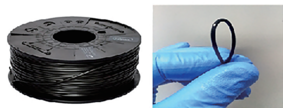
(d) PVA/IL/CNT FDM打印丝条
