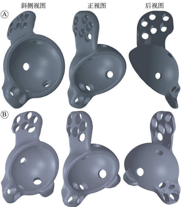
图 3 双翼假体(A)与三翼带翼假体(B)设计图 Fig. 3 Design of the dual flange (A) and the triflange (B)
