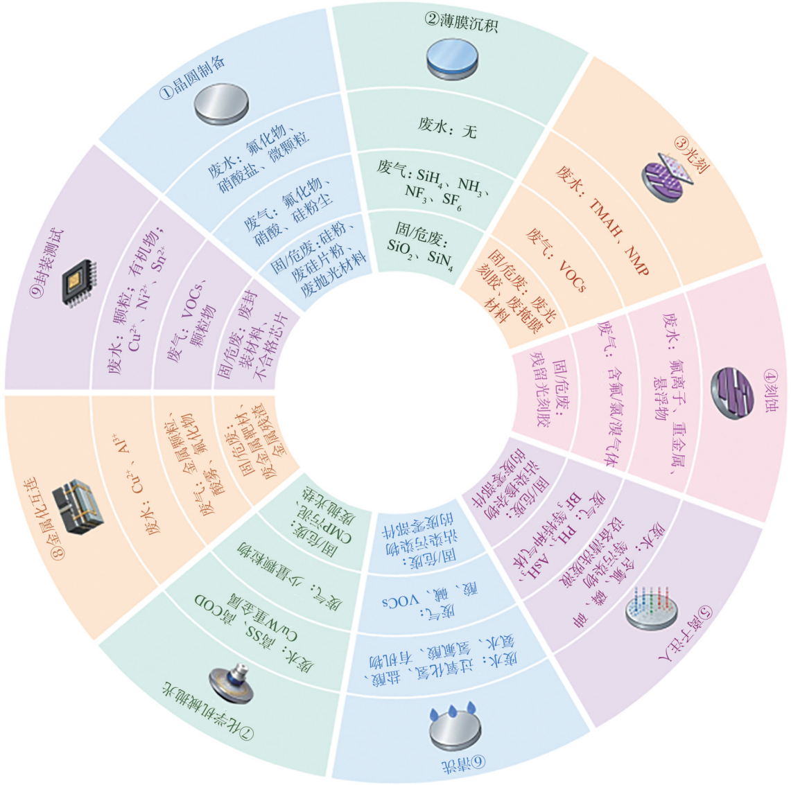
图1 芯片核心制造过程及其典型污染物
