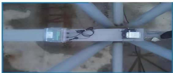
图 4 网架上方布置的力学传感器抓取设备
