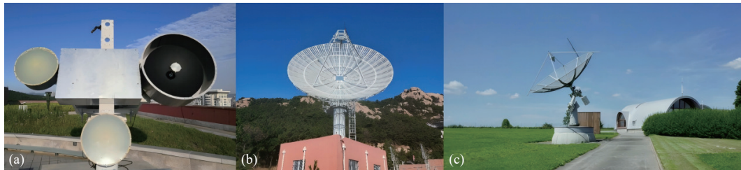
图 5 (a) 35~40 GHz 的毫米波太阳射电频谱观测系统; (b) 子午工程二期的榭山米波太阳射电频谱仪; (c) 比利时皇家天文台的 HSRS 射电频谱仪 (图片来源: https://sidc.be/humain/home )
