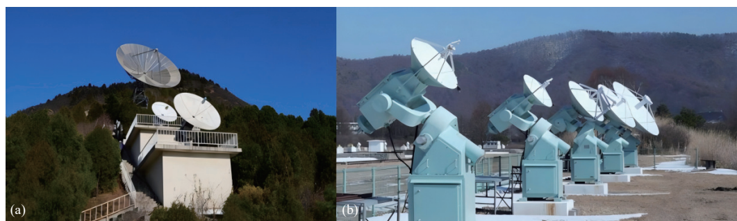
图2 (a) 国家天文台怀柔 F10.7 cm 射电流量计; (b) 日本野边山射电辐射流量计 NoRP (图片来源: https://sun.bao.ac.cn/SHDA/index.html ; https://www.nro.nao.ac.jp/en/public/teles.html )
