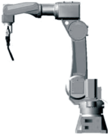
图2 焊接机器人三维模型
