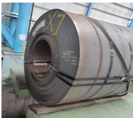
图7 海运 400 系不锈钢热轧黑皮卷被淋湿、结露腐蚀生锈
