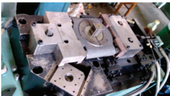
图 10 减速器壳体轴承座简化样件胀断试验装置
