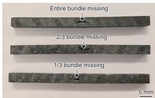
图 8 \text{SiC}_f/\text{SiC} 复合材料弯曲测试前的宏观形貌
