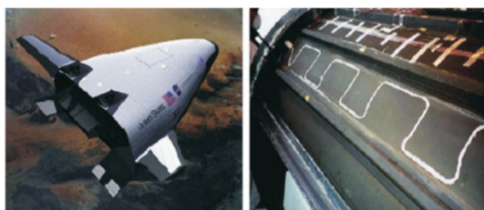
图6 X-33飞行器光纤传感器分布
