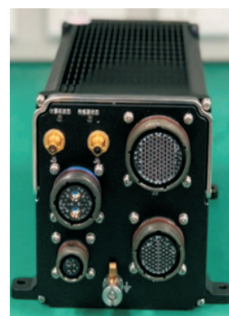
(a) DSCC-23A2型机载振动监测系统
