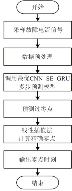
图6 复合模型零点预测流程 Fig.6 Composite model zero prediction flow
