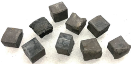
(b) 静爆试验回收长方体破片
