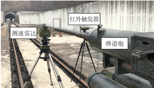
图1 测速试验现场布置
