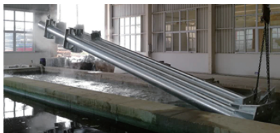
图 7 工件下钝化池钝化
