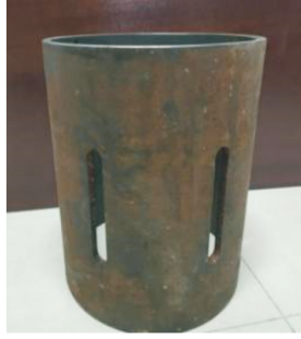
图6 竖条吸能构件试件 [33]
