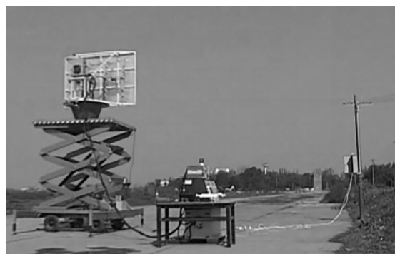
图1 四川大学2009年完成的200 m距离微波无线能量传输外场实验
