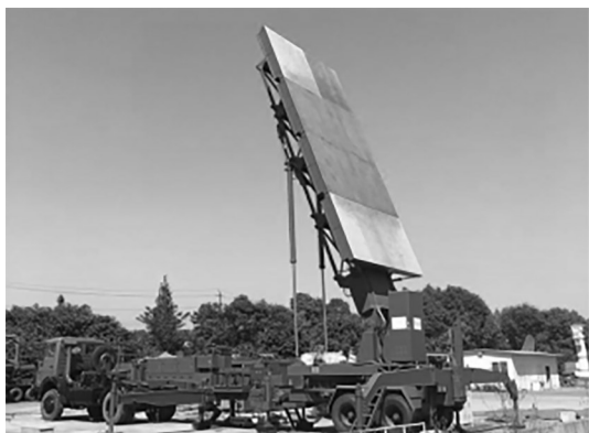
图7 机动式微波无线能量供给站
