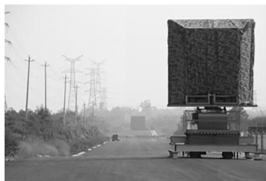
图 4 四川大学 2013 年完成的 1 km 距离微波无线能量传输外场实验
