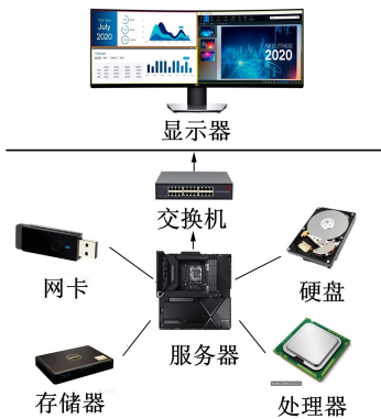
图 2 挖掘算法运行平台架构示意图
