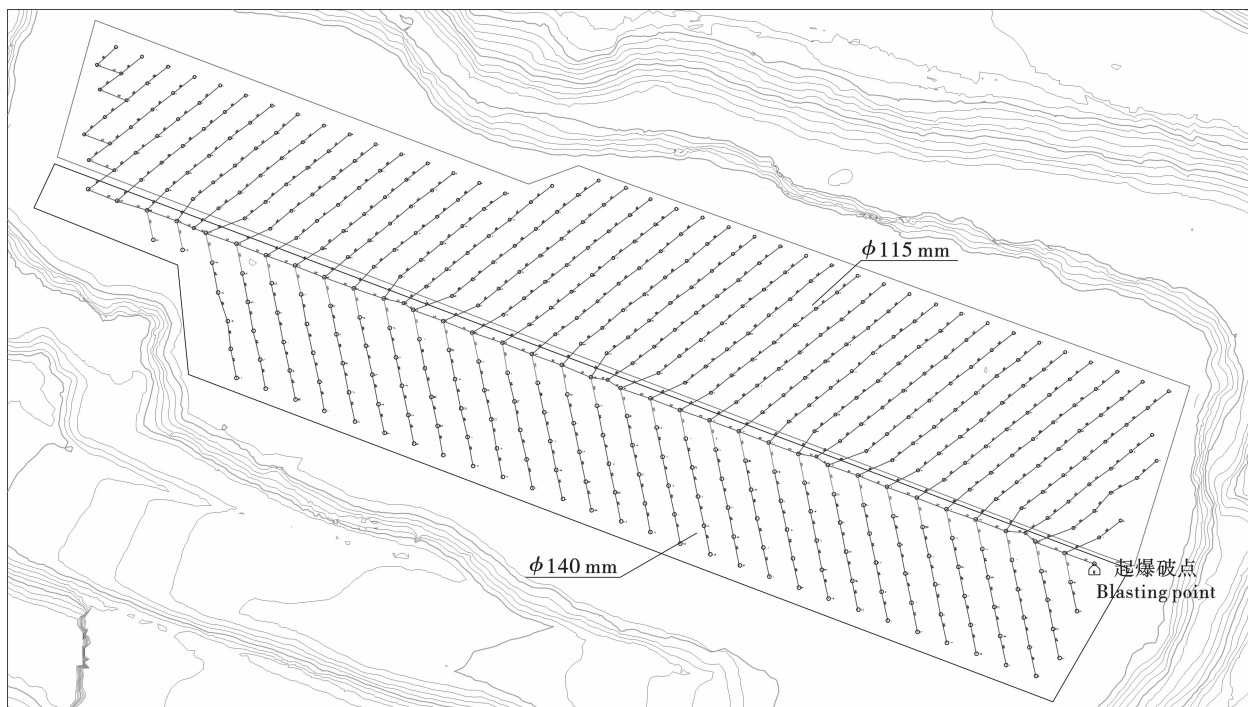
图 5 EII-C028-1323-001(矿)爆破网路示意图
