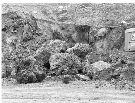
图 1 蜂窝状矿石区域爆破后产生的大块图片
