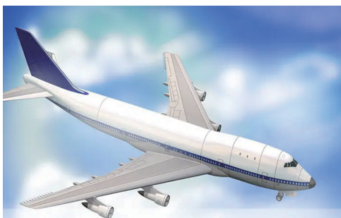
图8 飞机蒙皮是铝合金, 承力框架是硬铝和超硬铝
