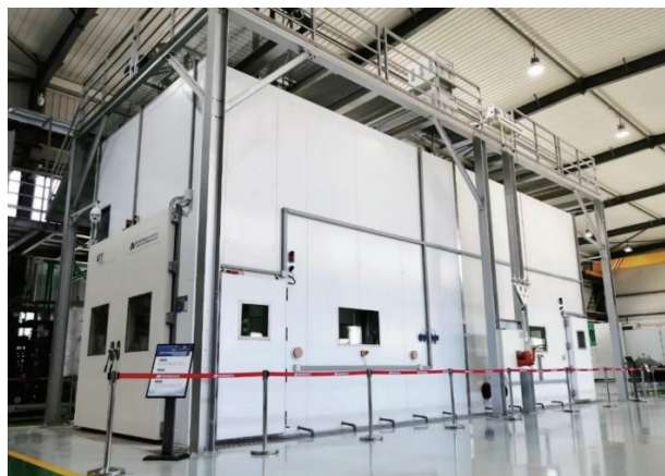
图5 自然大气环境结构材料试验装置
