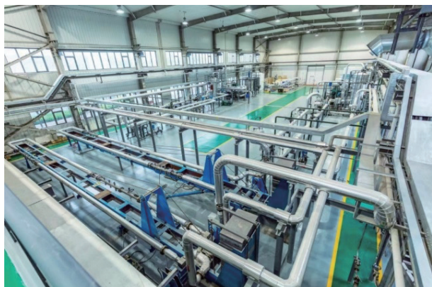
图3 多相流环境结构材料试验装置实景图
