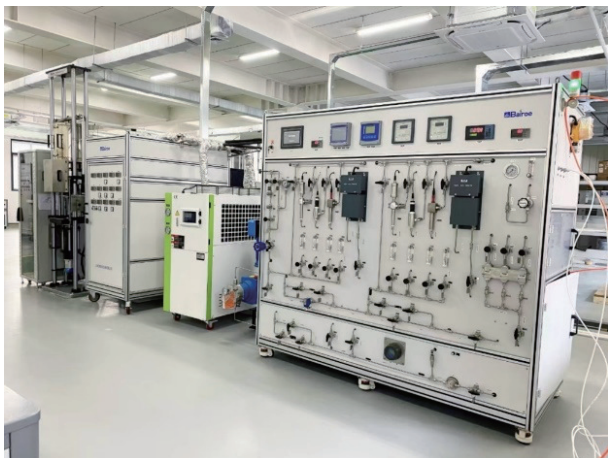
图8 极端/多因素耦合环境材料损伤试验装置部分设备实景图
