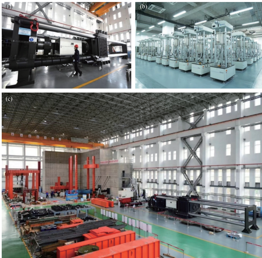
图7 力学-化学多场耦合环境结构材料试验装置实景图: (a) 可实现 2000 t 疲劳载荷、3000 t 静载荷卧式拉压试验机; (b) 超长时金属高温蠕变试验机群; (c) 试验装置全景图
