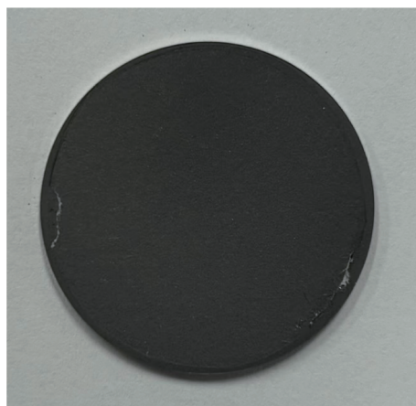
图 1 磨具压制成型的高质化钽片示例图
