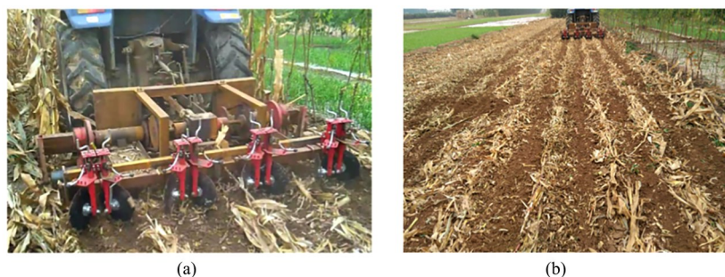
图 5 玉米秸秆顺行铺放机(a)及其田间作业效果(b)
