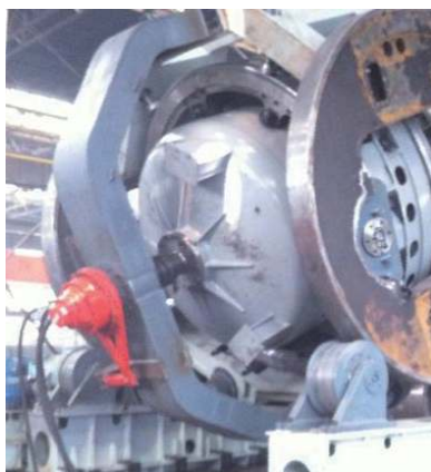
图 4 现场改造后底部液压马达驱动方式
