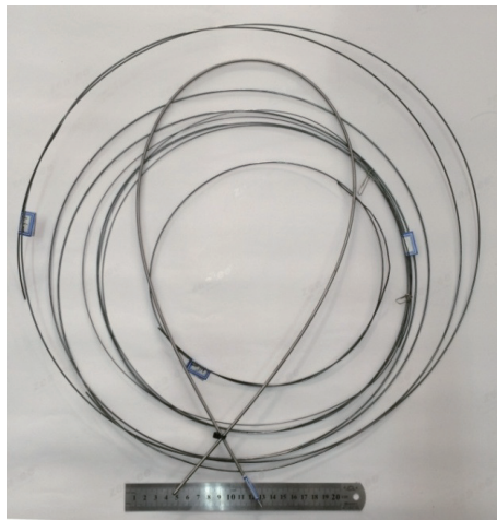
图2 热拉拔后的 \text{Al}_{0.3}\text{CoCrFeNi} 高熵合金丝材实物图
