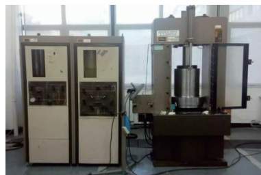
图1 MTS815.02岩石力学试验系统 Fig. 1 MTS815.02 rock mechanics testing system
