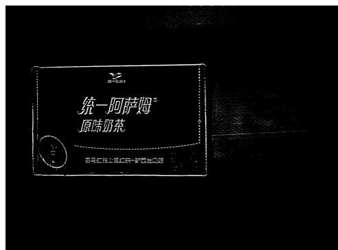
图 4 自适应阈值化处理后的图像实例
