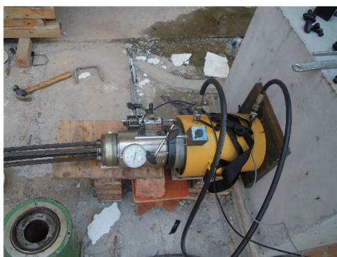
图7 锚索拉拔加载试验
