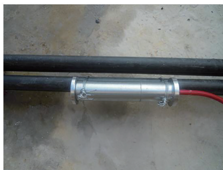
(a) 应变计固定在钢绞线上
