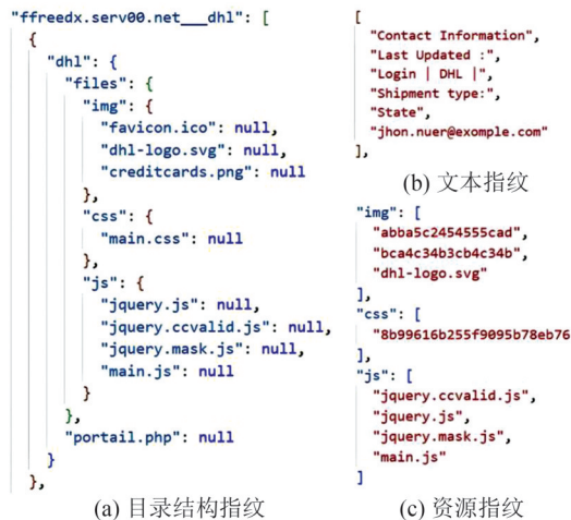
图 2 钓鱼工具包指纹示例 Fig. 2 Example of phishing toolkits fingerprints
