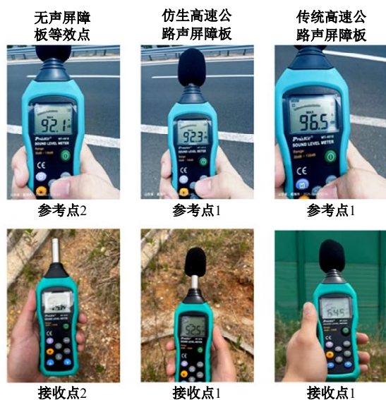
图 11 高速公路声屏障插入损失现场检测声压级
