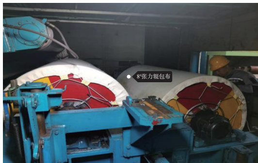
图 4 增加包布后的张力辊组
