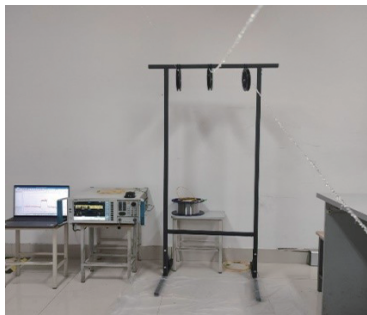
图 4 光纤监测系统 Fig.4 optical fiber monitoring system
