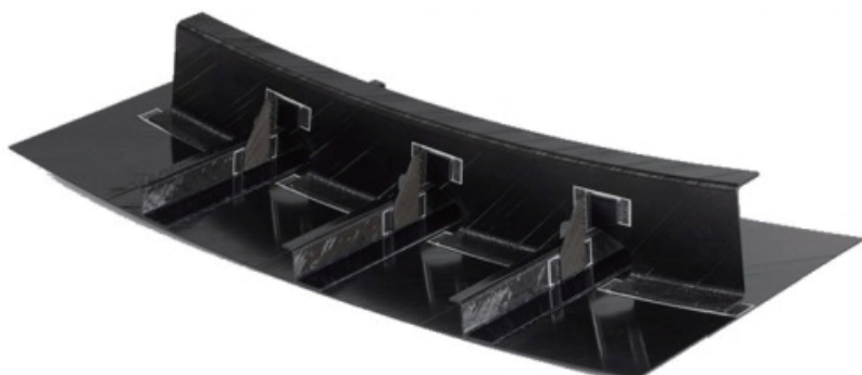
图 12 感应焊接制造曲面集成机身交叉件 [100]
