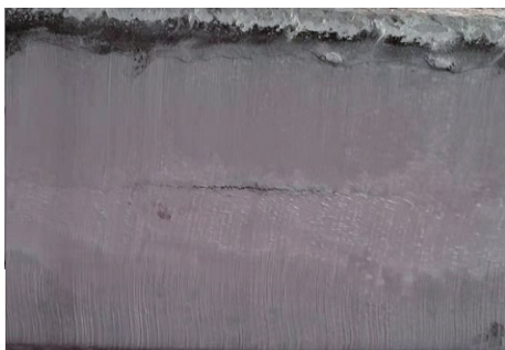
图 1 铸坯中心线裂纹
