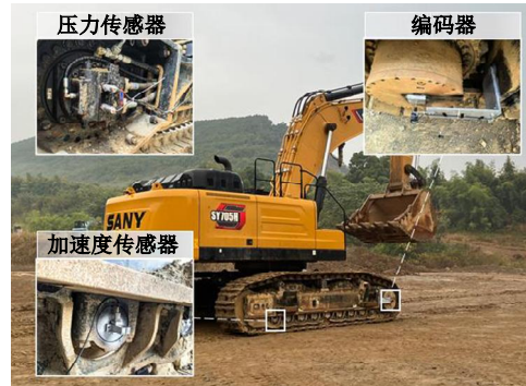
图4 传感器安装示意图
