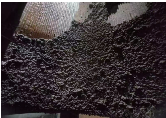
图3 炉口段黏渣现象
