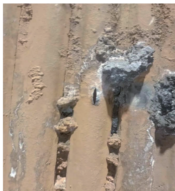
图 12 炉口段烟罩爆管
