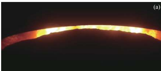
图 13 两座炉子活动烟罩降罩情况对比图：(a) 活动降罩降罩到位；(b) 活动烟罩降罩不到位
