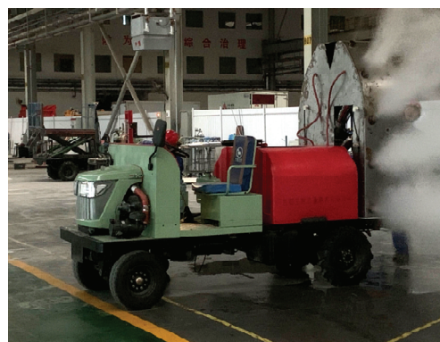
图 12 无风空间中喷雾机静态下的现场试验
