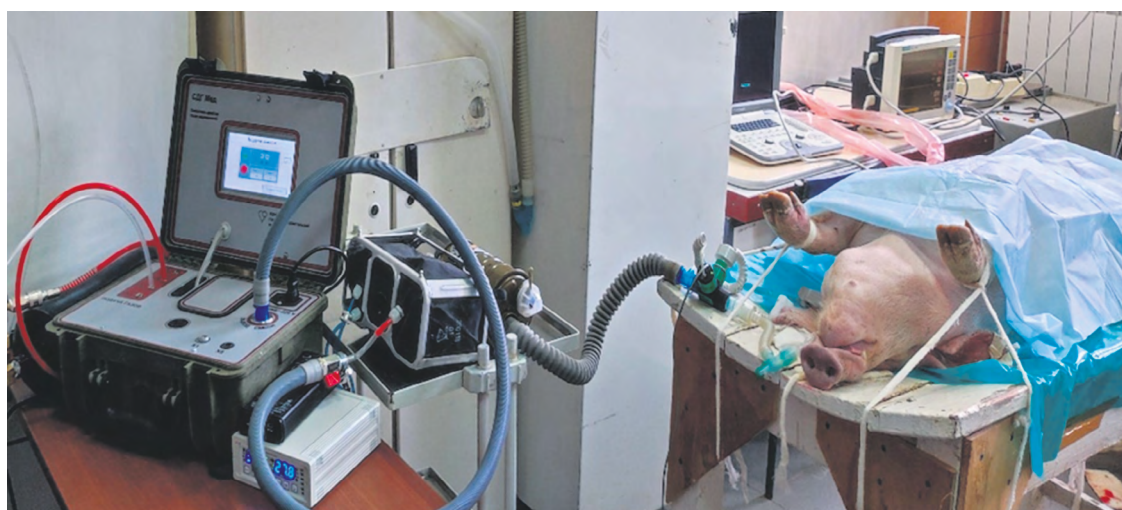
Fig. 2. Gas "Arroxen-krypto" supply through an automatic gas mixer Рис. 2. Подача газа «Аррохен-кrypto» через автоматический смеситель газов
