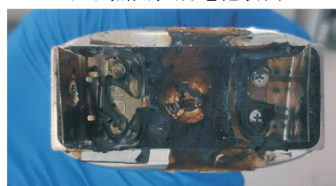
(c) 热失控后电池端盖
