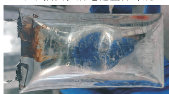
(b) 热失控后电池表面
