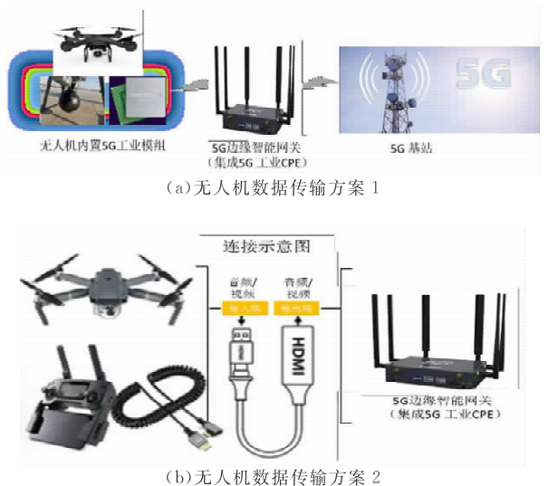
图 6 无人机 5G 数据传输方案设计示意图
