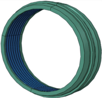
(b)内凹六边形负泊松比蜂窝结构弹带
