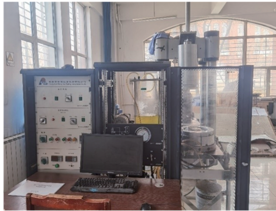
(b) TAW-2000 电液伺服试验机控制系统
