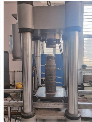
(c) TAW-2000 电液伺服试验机试验系统
